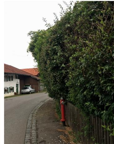
Nach den Bestimmungen des Bayerischen Straßen- und Wegegesetzes ist eine Durchgangs- bzw. Durchfahrtshöhe im Gehweg- und Radwegbereich von 2,50 Metern und im Fahrbahnbereich von 4,50 Metern freizuhalten. Bei den notwendigen Sichtdreiecken im Kreuzungsbereich ist die Bepflanzung außerdem unter einer Höhe von 0,80 Metern zu halten.
